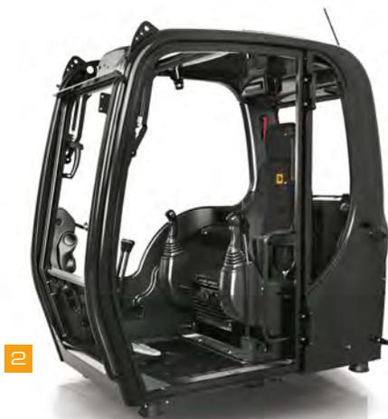
2 Para aumentar a segurança do operador, a cabine da linha NXT conta com proteção contra capotamento (ROPS). Também disponibilizamos de forma opcional proteções contra queda de objetos (FOPS), que são de fácil instalação graças à estrutura padrão da cabine de todos modelos da linha NXT da JCB. Para maiores informações consulte seu distribuidor JCB local.
