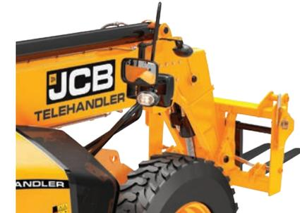
O Controle de Carga Adaptativo JCB monitora automaticamente o funcionamento hidráulico para ajudar a manter a estabilidade longitudinal do seu Loadall.
